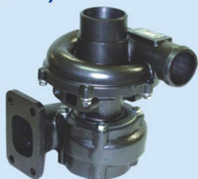
Турбокомпрессор сделан на современном уровне и адаптирован под работу с отечественными маслами. Современный подшипниковый узел (с установленной не вращающейся монобулейкой) работает как центрифуга, что позволяет использовать менее качественное масло и увеличивает ресурс работы подшипникового узла, при этом повышая качественные характеристики турбины.
