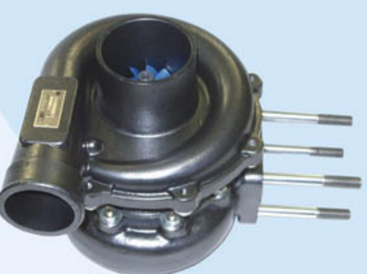
Турбокомпрессор изготовлен для массовых сельскохозяйственных двигателей, которыми комплектуются почти все отечественные экскаваторы и тракторы. Турбокомпрессор устанавливается на рядные 4-х цилиндровые дизели.
